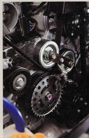
エンジン始動後の違和感で判明したカムポジションセンサーの違いは、FA20前期のセンサーがボルトオンで再利用可能だった。制御データはFA20、FA24で大きく異なっていたが、FA24の制御データを参照して特に苦勞することなく最適化できている。
