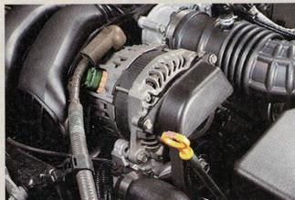
オルタネーターはブラケット加工でFA20用を使用。エアコンプレッサーはFA24用を使用しているが、配管類は加工せずFA20用が使用できた。
