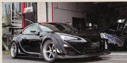
Z#6前期×FA24換装実現に使用されるマシンは、ターボチューンで最高速に挑んだ後にユーザーへと譲り渡された元デモカーだ。ホルクレーシングTE37Vの10Jを前後にセットするため、今回の公認取得時にはパリスのワイドボディキットも投入された。
